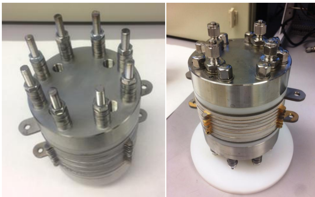
Figura 8. Imágenes de los prototipos de stacks de 0.5 kW (izquierda) y 1 kW (derecha) fabricados en el proyecto.
