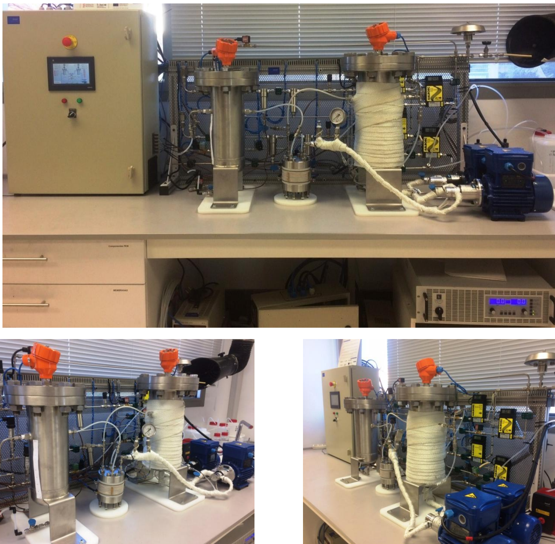
Figura 9. Banco de pruebas de electrolizadores PEM.
