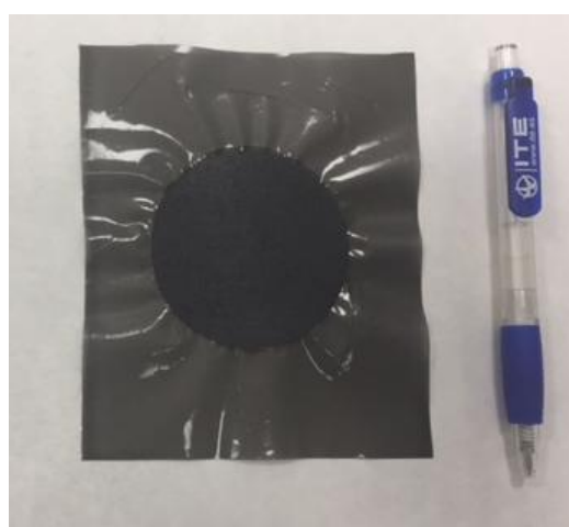
Figura 5. MEA con componentes desarrollados en el proyecto
